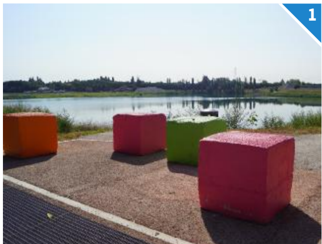
BARRIERE COLORATE. All'ingresso della pista ciclopedonale del Parco delle Cave si trovano dei cubi colorati che proteggono i pedoni e i ciclisti dal potenziale ingresso di mezzi motorizzati.
